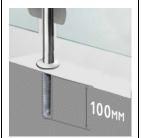
Крепление стойки путем алмазного сверления (кафель, гранит, бетон) в ступень отверстие 42 мм. Стойка анкерируется гидравлическим цементом
